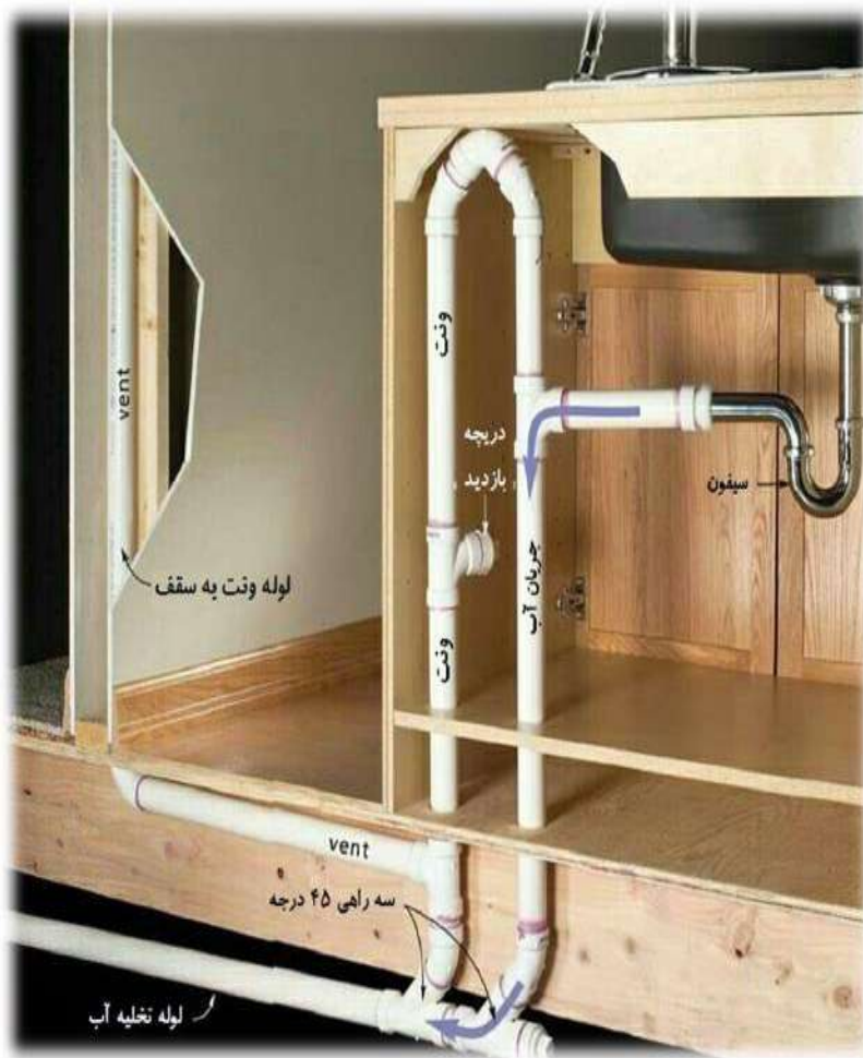
لوله کشی ونت در لوله کشی فاضلاب سینک ظرفشویی جزیره ای
